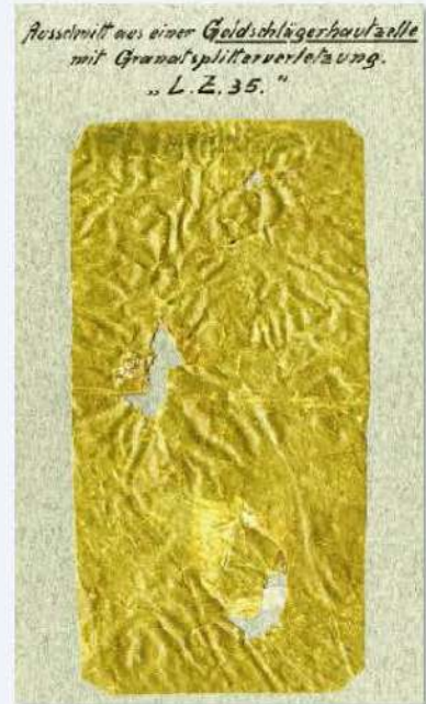
Ausschnitt aus einer Goldschlägerhautzelle von LZ 35.
